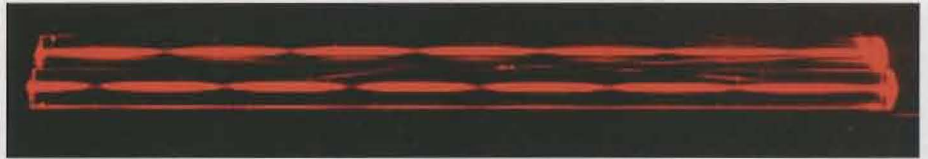
Abb. 2, untere Hälfte: Laserstrahl in einem Plexiglasrundstab ( d \approx 10 mm, wie in Abb. 1) mit polierten Außenflächen für folgende Bedingungen: Der Laserstrahl tritt von links in den Stab senkrecht zur Schnittfläche ein und verläuft parallel zur Längsachse des Stabs; die Schwingungsebene des Lichts liegt parallel zur Bildebene; die optische Achse des Stabs ist dazu um 45^\circ geneigt; beobachtet wird senkrecht zur Schwingungsebene des Lichts und senkrecht zur Ausbreitungsrichtung; Lichtquelle: He-Ne-Laser mit P = 2,0 mW und \lambda = 632,8 nm; gemessener Knotenabstand: d_\lambda = 34 mm. Im Außenraum wurde kein Rauch mehr verwendet. Obere Hälfte: gleiche Bedingungen mit der Ausnahme, daß jetzt parallel zur Schwingungsebene des Laserlichts beobachtet wird. Zur gleichzeitigen Registrierung wurde die Beobachtungsrichtung mit einem Spiegel um ca. 90^\circ entsprechend gedreht.
