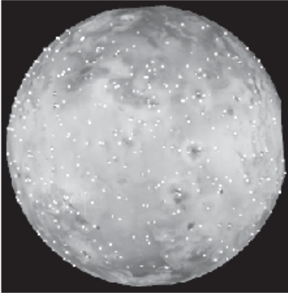
Abb. 6: Das DLR Io Kontrollnetz. Darstellung der auf der jupiterabgewandten Hemisphäre liegenden Kontrollpunkte. Eine gleichmäßige und homogene Abdeckung bis in hohe Breiten wurde erzielt.
